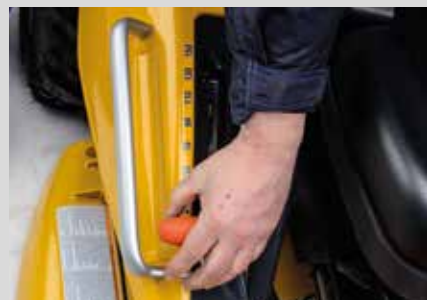
Zeskalowana regulacja wysokości cięcia
