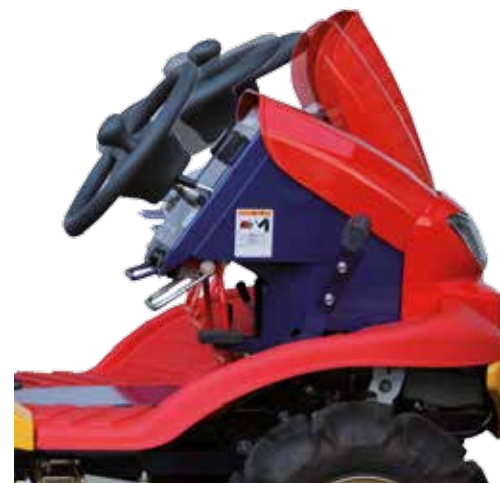
Regulacja pochylenia kierownicy, maks. 30°
