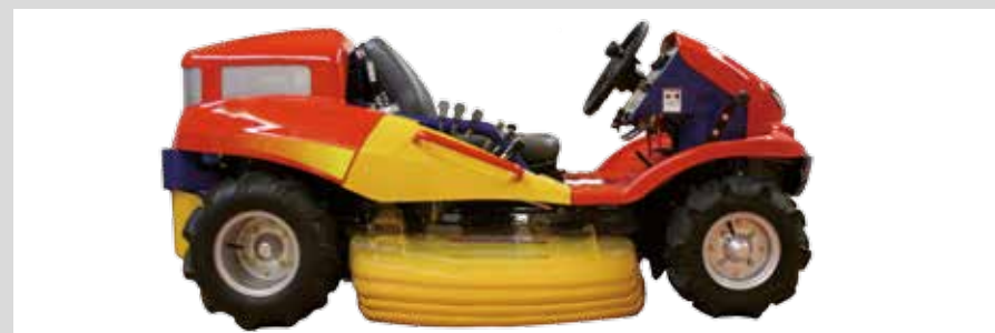
21-stopniowa regulacja wysokości koszenia od 0 do 150 mm
