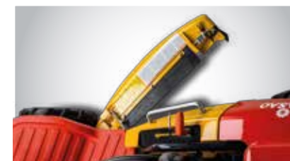
Zamykanie urządzenia tnącego (z lewej lub prawej strony)
