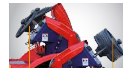
Regulacja pochyleń kierownicy
