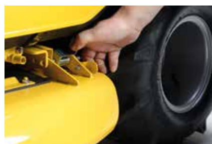
Szybkie zamknięcie bocznego wyrzutu
