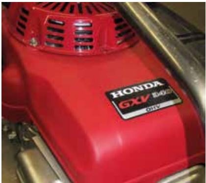
Wysokiej wydajności silnik Honda o mocy 6,6 kW/ 9 kM (model CM 65)
