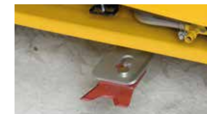
Beznarzędziowa wymiana noża (oprócz modeli CM 1401, CMX 1402)
