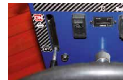
Dźwignia blokady mechanizmu różnicowego
