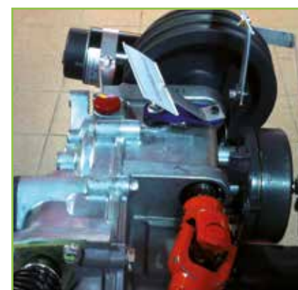
Mechaniczna 2-stopniowa skrzynia biegów
